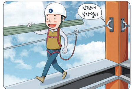
안전대 착용 및 부착설비 설치
